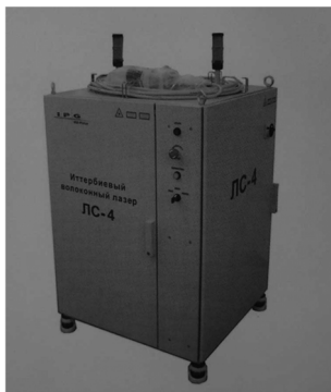
Рис. 6.2 Иттербиевый волоконный лазер киловаттного диапазо- на (ЛС-XX (25U))
