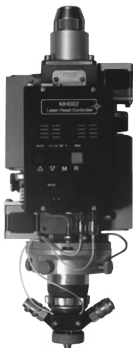
Рис. 5.6 Лазерная технологическая головка с переменным фокусным расстоянием VF001M и принцип магнитной фиксации технологических насадок
