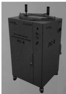
Рис. 6.3 Иттербиевый волоконный лазер киловаттного диапазона (ЛС-XX (31U))
