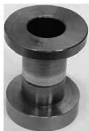
Рис. 7.9 Пример сварки разнородных металлов — сталь 10895 с бронзой БрОФ6,5-0,15. Образцы после проточки и разрезки
