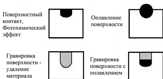
Рис. 7.10 Типы воздействия лазерного излучения на поверхность обрабатываемого материал
