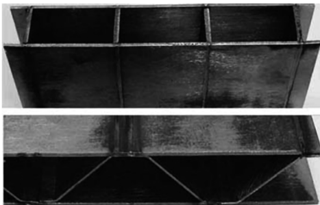
Рис. 7.8 Макеты сэндвич-панелей, изготовленных лазерной сваркой «напроплав»
